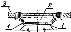
**Крепление проводов ВЛ 6-10 кВ на шейке изоляторов ШФ10-Г и ШФ20-В с помощью скобы**
