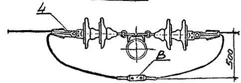
Зажимы для соединения проводов А 95 и А<sub>п</sub> 120 с проводами меньших сечений в петлях анкерных опор (поз. В, схема 4)
