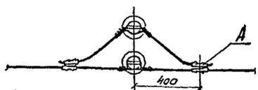
Зажимы для двойного крепления проводов и соединения проводов одной марки и сечений в петлях анкерных опор (поз. А, схемы 1, 2 и 5) Таблица 1
